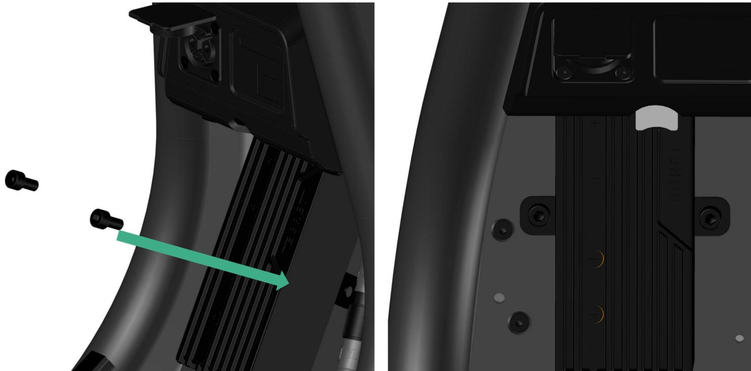
1. Befestige den Controller wieder, indem du diesen mit den beiden Schrauben (H 3) beidseitig fixierst und diese handfest mit ca. 4 Nm anziehst.
